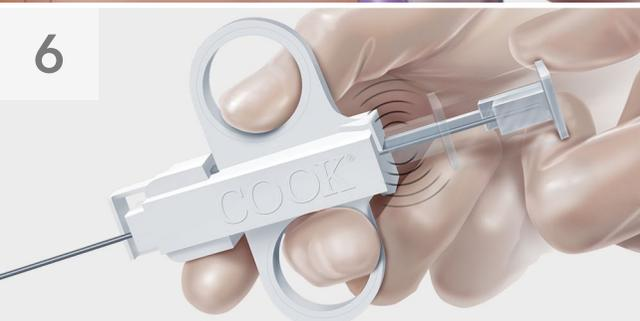
カチッと手応えを感じるまで、Quick-Core® Biopsy Needle のプランジャーを手前に引くと、生検針のスプリングがロックされ待機状態となります。この時点では、採取ノッチはカッティングカニューラに完全に覆われています。
